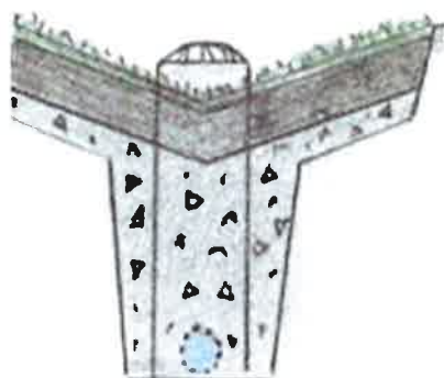
Bild 14. Princip för infiltrationsstråk med kupolbrunn
