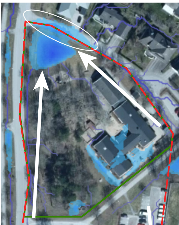
Figur 10. Projicering av skyfallsvägar och översvämningszoner via SCALGO för utredningsområde 1 (grön markering). Vita pilar visar flödesriktningar och vit oval visar lågpunkt vars höjdvärden är vägledande för val av lägsta färdiga golvhöjd.
