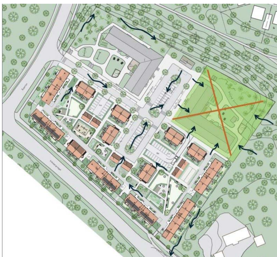
Figur 20: Exempel på avrinning av dagvatten inom planområdet. Bild: Norconsult Sverige AB.
